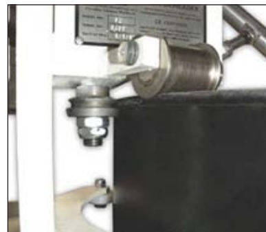
Corta sobre el doblado de la orilla
