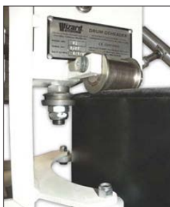
Corta sobre el doblado de la orilla
